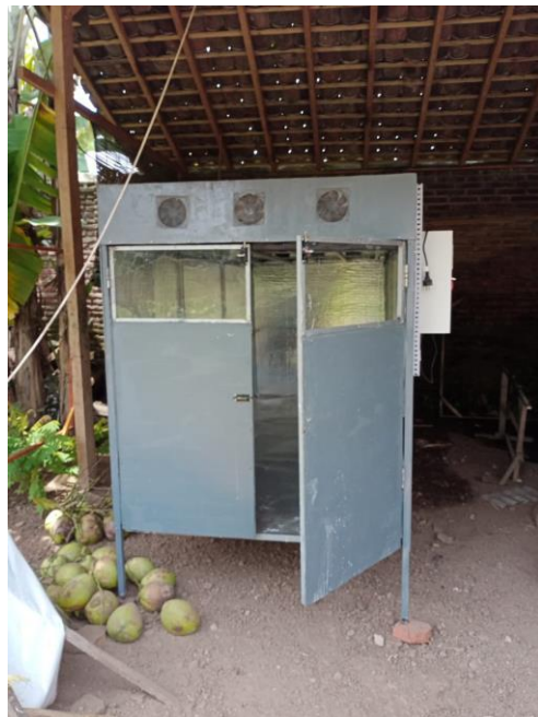
Gambar 4. Alat Pengering Batik
